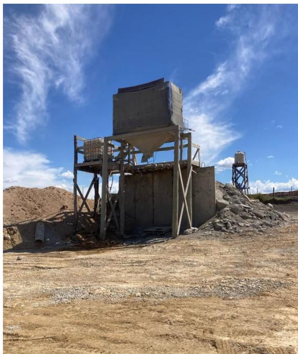
*Ilustración 3: Tolva de hormigón con malla de para disminuir las emisiones al aire.*
