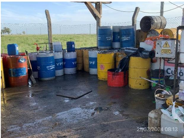
Foto 12.1-9, P04. Zona enmallada y con pavimento impermeable para acopio de productos químicos y lubricantes.
