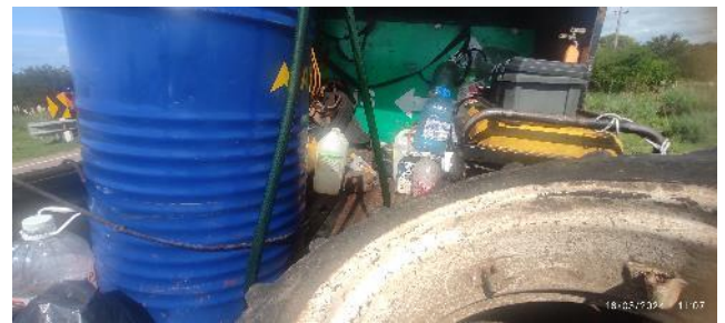
Foto 12.3-1 Tanques con combustible y otros productos químicos sin dique de contención.
