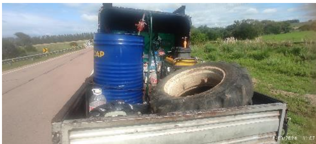
Foto 12.3-1 Tanques con combustible y otros productos químicos sin dique de contención.
