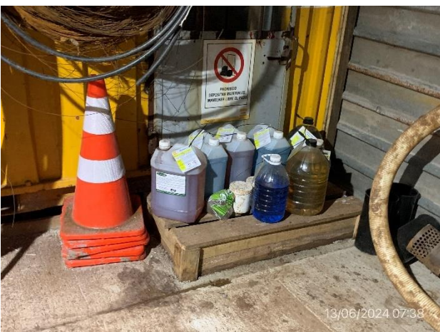
Foto 12.1-5, P02. Pañol. Lubricantes en local sin envallar ni bandejas que prevengan eventuales derrames.
