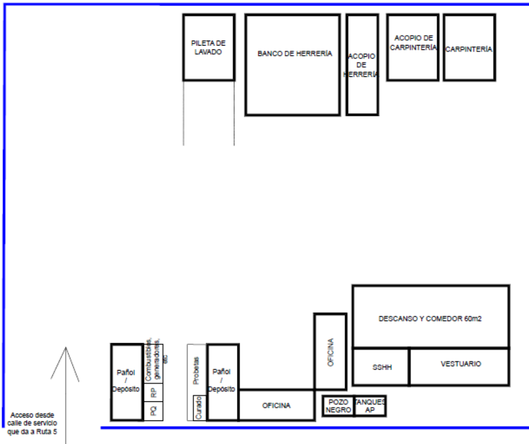
Figura 6-3: Ubicación y croquis del obrador Viaducto camino 60
