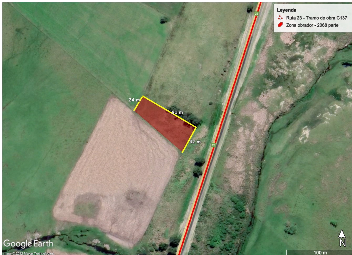
Imágen 2 - Ubicación y dimensiones del obrador
