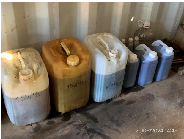
Foto 12.1-11, P03. Pañol con bidones de combustible sin contenciones para prevención de eventuales derrames.
