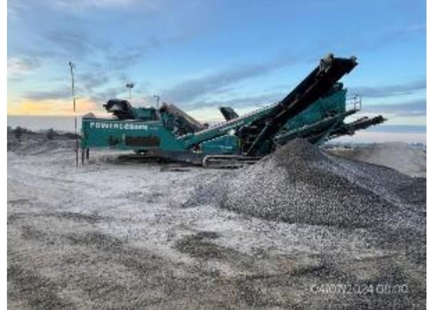
Foto 12.2-2, P10. Cantera de piedra. Tren de trituración en operación.
