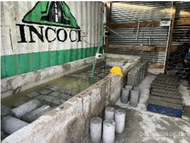
Foto 12.2-15, P03. Obrador, Laboratorio de hormigón, sector de curado de probetas ordenado.
