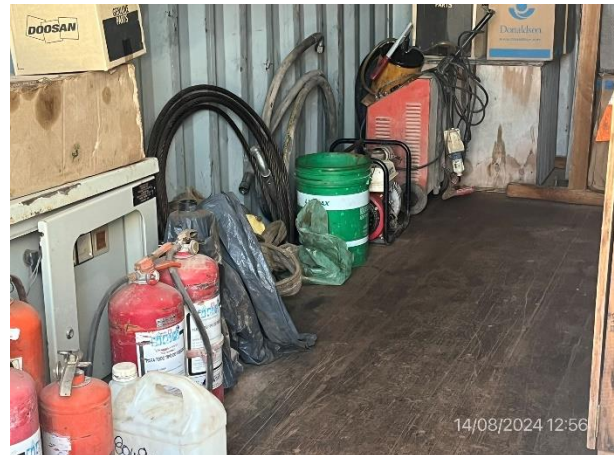
Foto 12.1-16, P04. Pañol, hay bidones de lubricantes sin contenciones para eventuales derrames.
