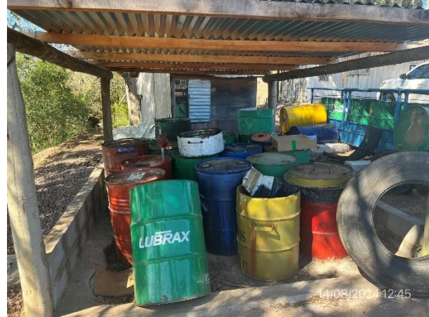
Foto 12.1-14, P04. Acopio de tarrinas de lubricantes en sector envallado y con pavimento impermeable.
