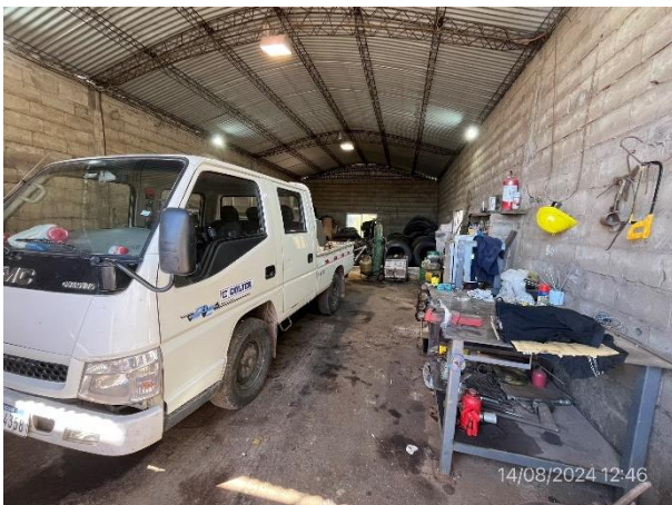
Foto 12.1-17, P04. Taller mecánico cerrado y con pavimento impermeable.
