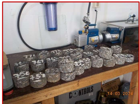
Especímenes elaborados y testigos de pavimento para control de calidad de la mezcla asfáltica.
