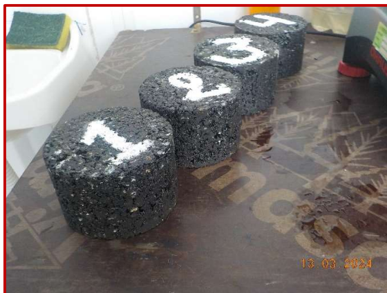
Especímenes elaborados y testigos de pavimento para control de calidad de la mezcla asfáltica.
