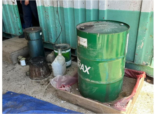
Foto 12.2-2, P03. Laboratorio de asfaltos, envase para contención del percloroetileno usado sin capacidad suficiente.
