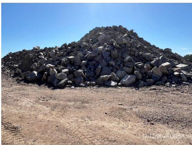
Foto 12.1-3, P05. Cantera, acopios de piedra volada al servicio de las obras del Consorcio.
