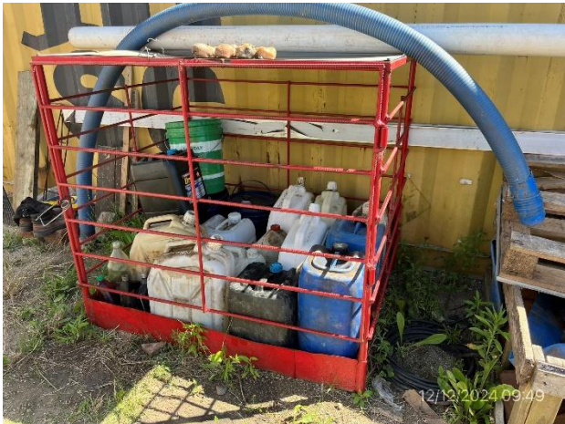
Foto 12.3-3, P06. Lubricantes alojados en bandeja impermeable
