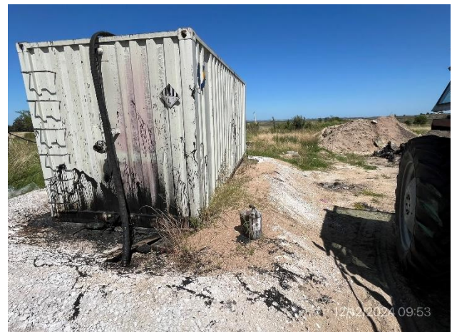
Foto 12.3-6, P06. Depósito de emulsión asfáltica. Hay derrames pendientes de ser tratados como residuos contaminados.
