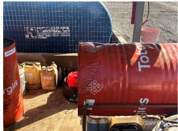
Foto 12.2-4, P03. Recinto cerrado y envallado para acopio de bidones con hidrocarburos.
