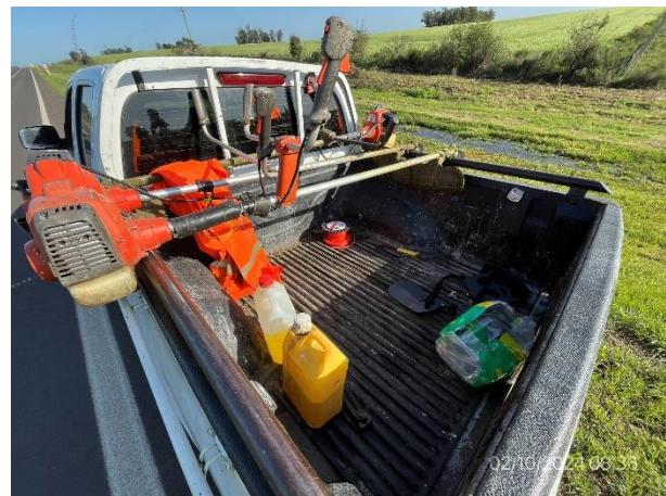
Foto 12.1-4, P04. Móvil de apoyo a la cuadrilla de áreas verdes, carece de bandejas para prevenir derrames.
