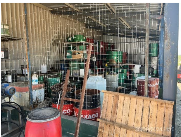
Foto 12.1-5, P05. Sector correctamente envillado y techado para alojar lubricantes y productos químicos.
