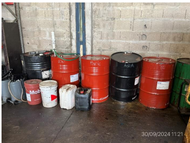
Foto 12.1-9, P05. Taller mecánico, tarrinas de lubricantes alojadas fuera de los sectores envallados existentes en el predio.
