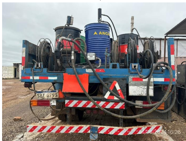
Foto 12.2-6, P03. Camión – taller mecánico de mantenimiento liviano dotado de bandejas para control de derrames.
