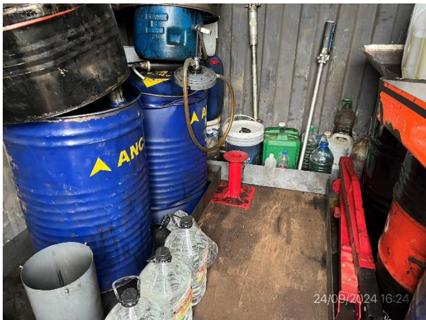
Foto 12.2-3, P03. Depósito cerrado para acopio de lubricantes correctamente envasado
