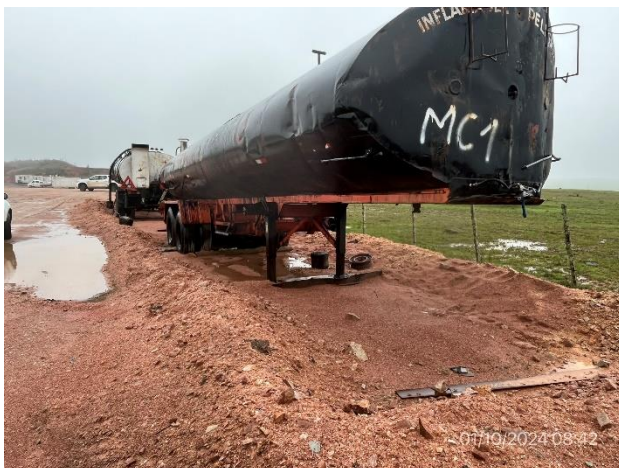
Foto 12.2-15, P03. Cisternas de emulsión, el envallado perimetral no contiene el 110% de un posible eventual derrame.
