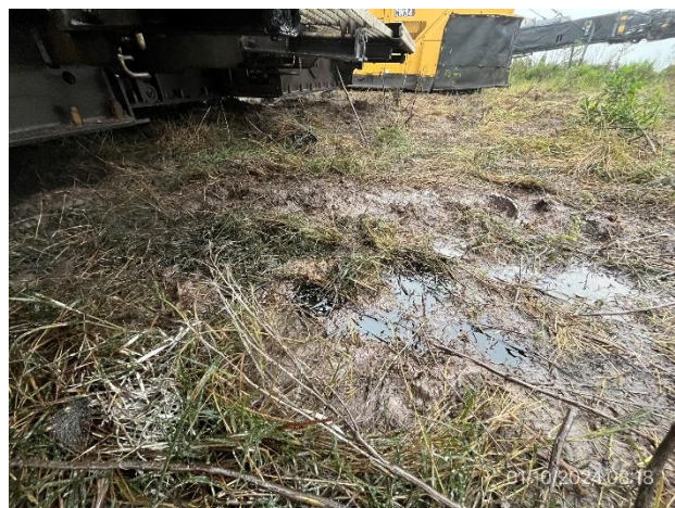
Foto 12.2-4, P06. Restos oleosos volcados sobre suelo desnudo que no fue tratado como residuo contaminado.
