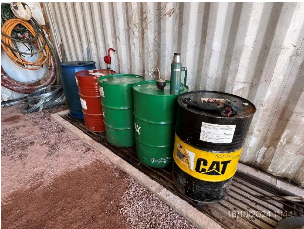
Foto 12.1-5, P03. Obrador. Acopio de lubricantes en local techado, envallado limpio, libre de residuos oleosos.
