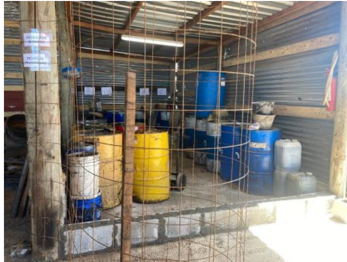
Foto 12.3-1, P03. Obrador, local techado para acopio de lubricantes. El envallado fue completado en todo su perímetro.
