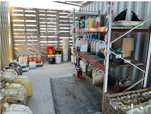
Foto 12.1-5, P03. Obrador, depósito de lubricantes en sector envallado y techado.
