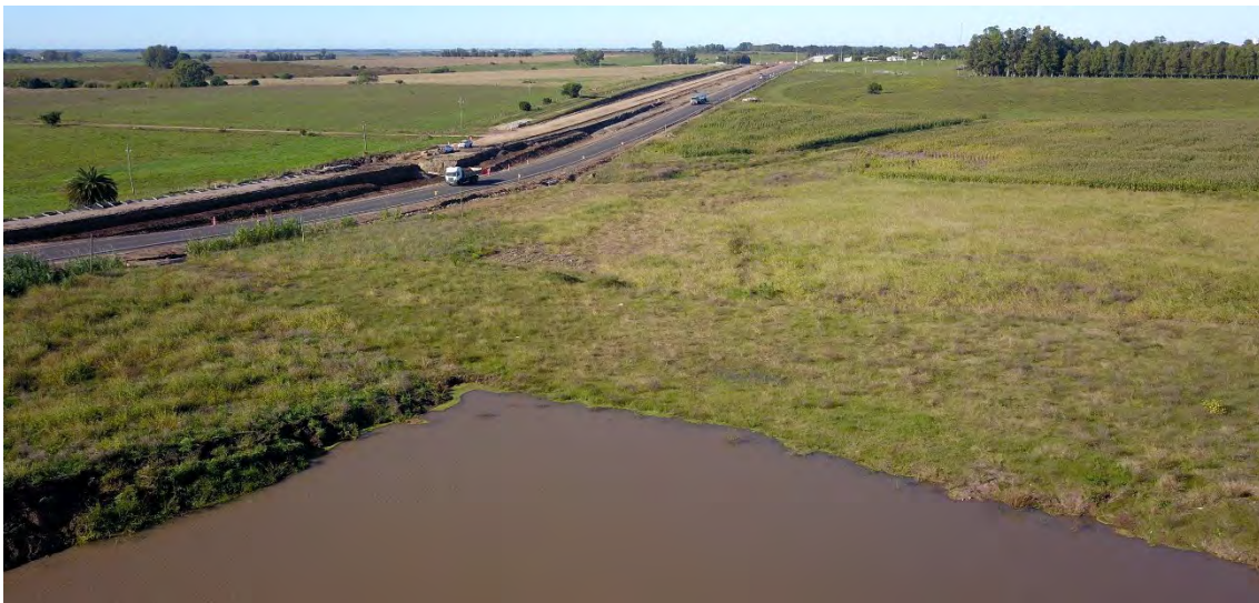
Foto 4. Extremo Sureste de la antigua cantera, hoy totalmente anegada. El vertido al sistema hidrográfico superficial es de forma laminar, no encauzada, sobre un terreno completamente vegetado.
