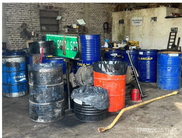
Foto 12.1-10, P03. Taller mecánico, tarrinas con lubricante fuera del sector envallado por falta de capacidad.
