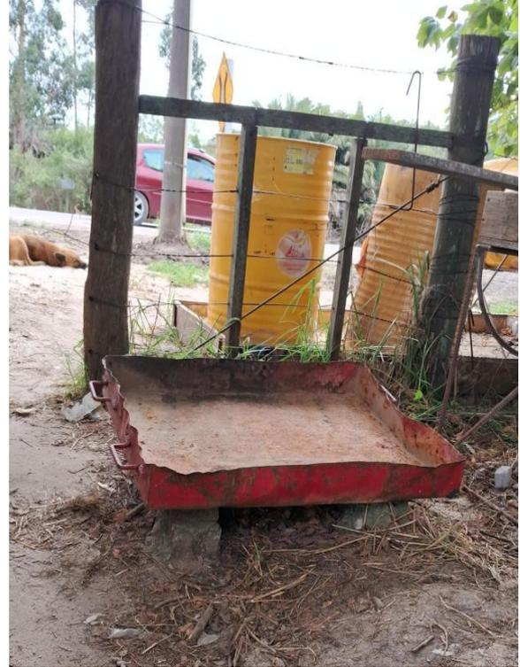
Foto 12.3-2, P02. Se incorporaron bandejas para la maniobra de recarga de combustibles y lubricantes.
