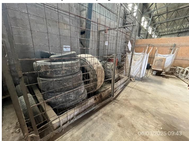
Foto 12.2-11, P03. Obrador, acopio de cubiertas usadas a cubierto sobre superficie impermeable.
