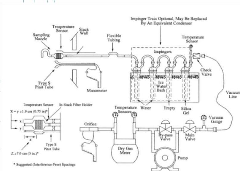
Figura 1: Esquema del tren de muestreo IN-STACK.
