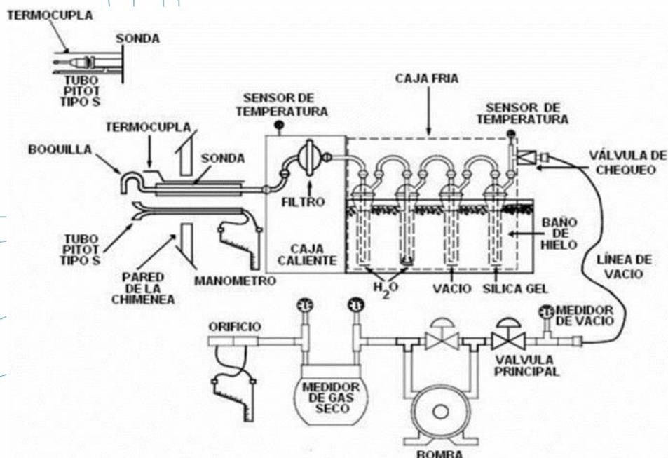
Figura 2: Esquema del tren de muestreo OUT-STACK.
