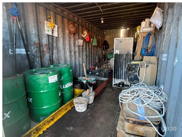
Foto 12.2-6, P03. Local cerrado para acopio de lubricantes con envallado correcto.
