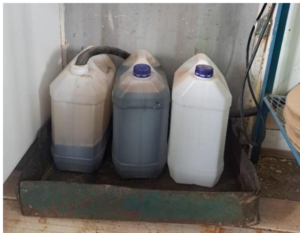
Foto 12.3-1, P03. Se colocó bandeja para contención de posibles derrames de bidones de percloroetileno en el laboratorio.
