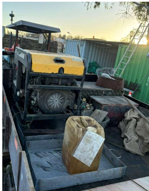
Foto 12.3-2, P02. Se colocaron bandejas para prevención de eventuales derrames.
