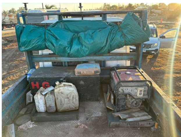
Foto 12.3-3, P02. Móvil de apoyo. Se sumaron bandejas para prevención de eventuales derrames.
