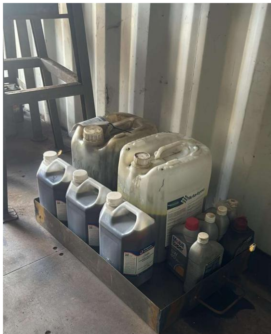
Foto 12.3-1, P03. Obrador de CVC SA, pañol. Se colocaron bandejas para prevención de eventuales derrames.
