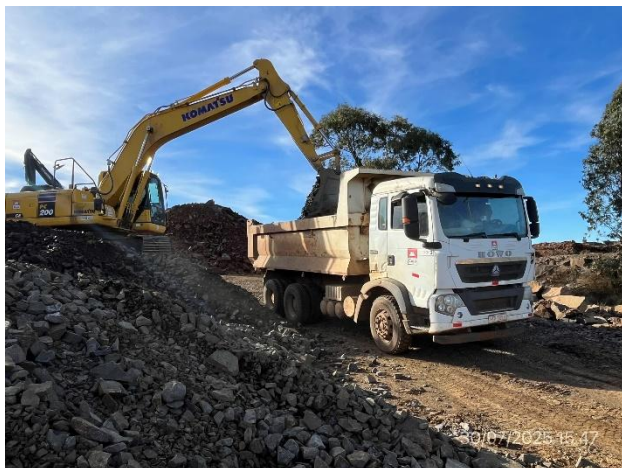
Foto 12.1-17, P03. Cantera de piedra, carga y transporte de material triturado primario
