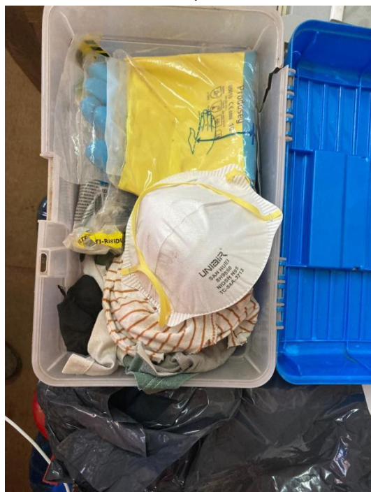
Foto 12.3-3, Frente de obras. Contenido del kit para actuación ante derrames: bolsas, trapos, lentes, guantes y mascarilla.
