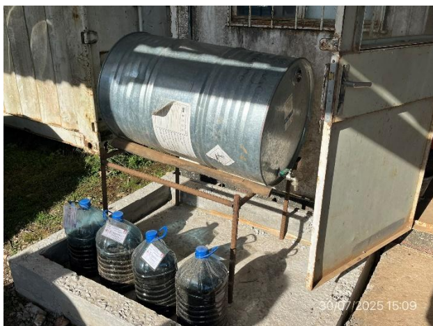
Foto 12.1-9, P03. Laboratorio de asfaltos, acopio de percloroetileno usado correctamente acopiado en recinto envallado y bajo techo.
