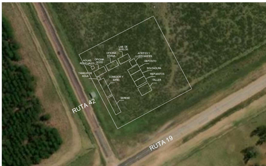
Plano de distribución del obrador
