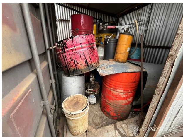
Foto 12.1-11, P03. Pañol y taller de la planta de asfalto, hay tarrinas con lubricantes fuera de los sectores envallados previstos.
