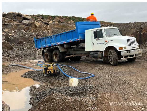
Foto 12.1-14, P03. Cantera, bidones de combustible directamente apoyados sobre suelo desnudo
