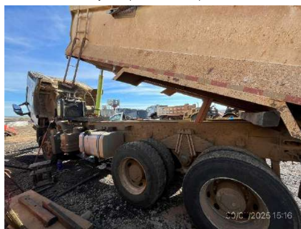
Foto 12.1-4, P03. Se ejecuta mantenimiento mecánico fuera de la zona impermeable y sin bandejas.
