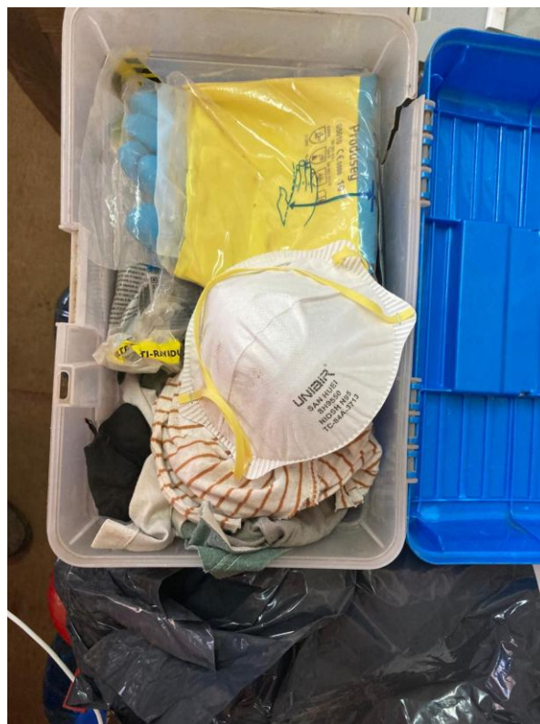
Foto N°4 Y 5: Contenido del kit de derrame: bolsas, trapos, lentes, guantes y mascarilla.
