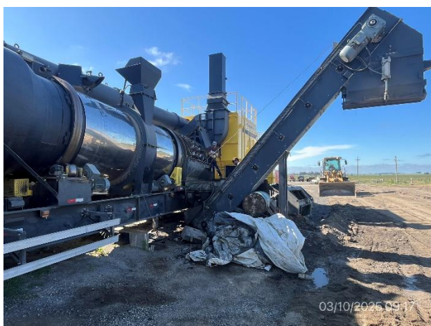
Foto 12.1-3, P03. Planta asfáltica en parada de mantenimiento genera residuos contaminados a disponer, pero falta infraestructura para su acopio temporal.
