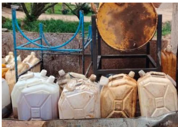
Foto 12.5-1, P01. Se coloca bandejas de contención bajo bidones con productos químicos y se etiquetaron
