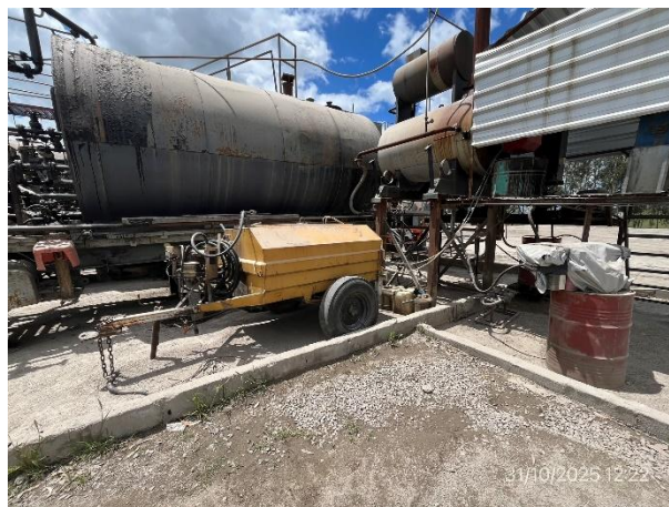
Foto 12.1-2, P03. Planta asfáltica, envallado perimetral correcto, garantiza estanqueidad.
