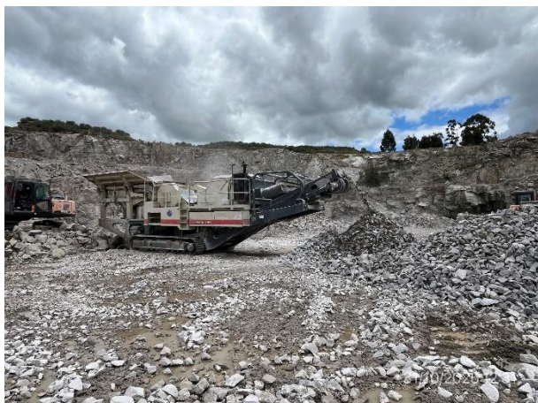
Foto 12.1-11, P03. Planta de trituración primaria. No está presente la infraestructura para el acopio temporal de residuos segregados desde origen.
