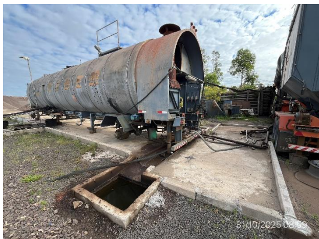
Foto 12.1-3, P02. Planta asfáltica, envallado perimetral correcto con pendiente hacia decantador.
