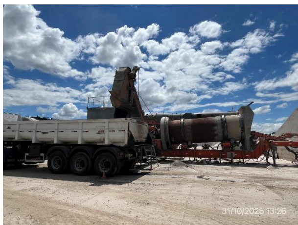
Foto 12.1-9, P03. Planta Asfáltica en funcionamiento, proceso de carga de cazamba en proceso.
