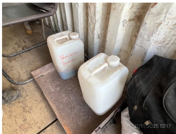
Foto 12.1-12, P03. Laboratorio de asfaltos, percloroetileno usado en recinto cerrado y alojado en bandeja con contención.
