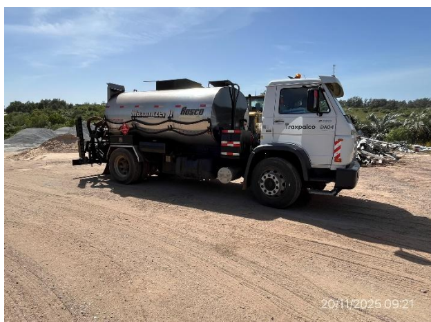
Foto 12.2-5, P04. El estacionamiento de cisternas de hidrocarburos no cuenta con elementos de contención que aseguren un perímetro estanco para retener derrames.
