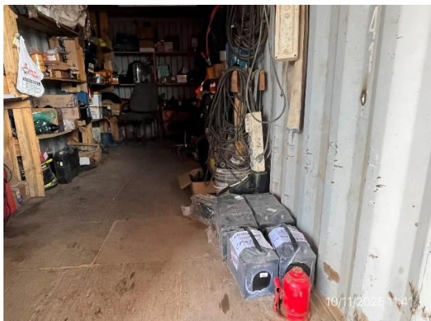
Foto 12.1-7, P03. Pañol, buenas condiciones de orden y limpieza. Las baterías no cuentan con contención estanca.
