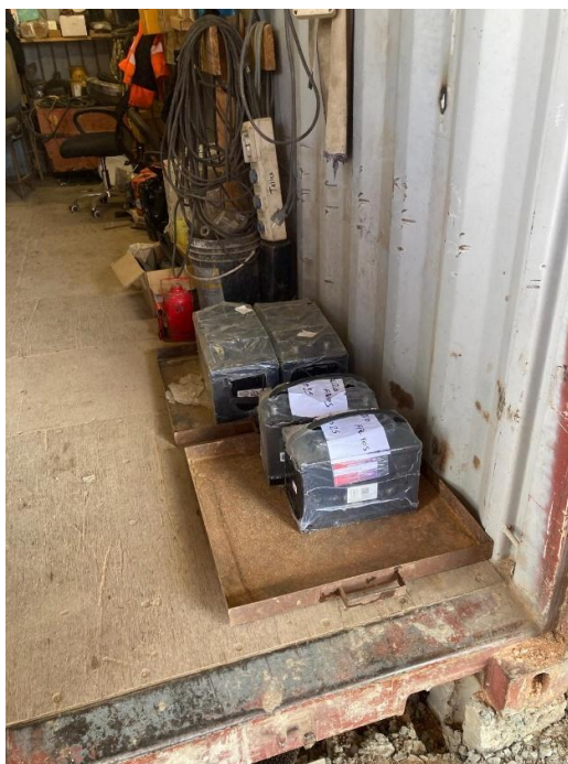
Foto 12.3-1, P03. Obrador, pañol. Se incorporaron bandejas estancas bajo baterías.
