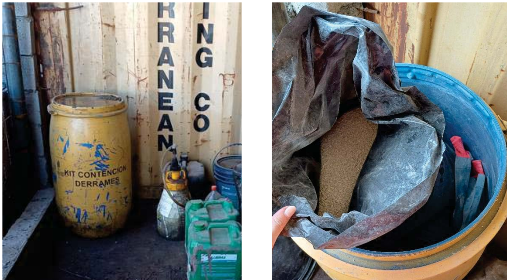
Figura 6-1: Kit para la contención de derrames, ubicado dentro del recinto de combustibles.
