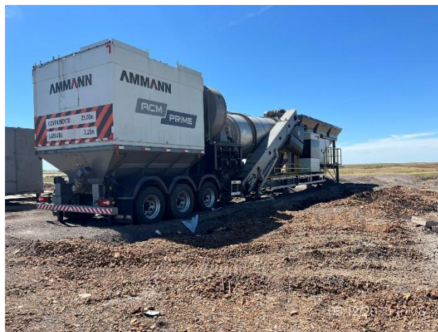
Foto 12.1-2, P03. Planta asfáltica en proceso de desmontaje.
