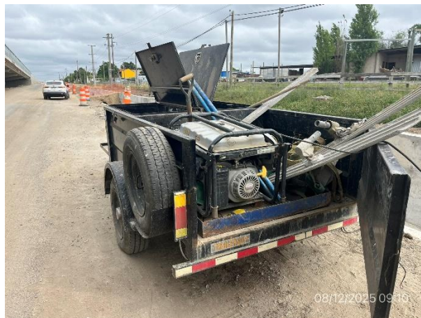
Foto 12.1-8, P01. Frente de obras, el grupo electrógeno cuenta con una bandeja estanca para prevenir eventuales derrames.
