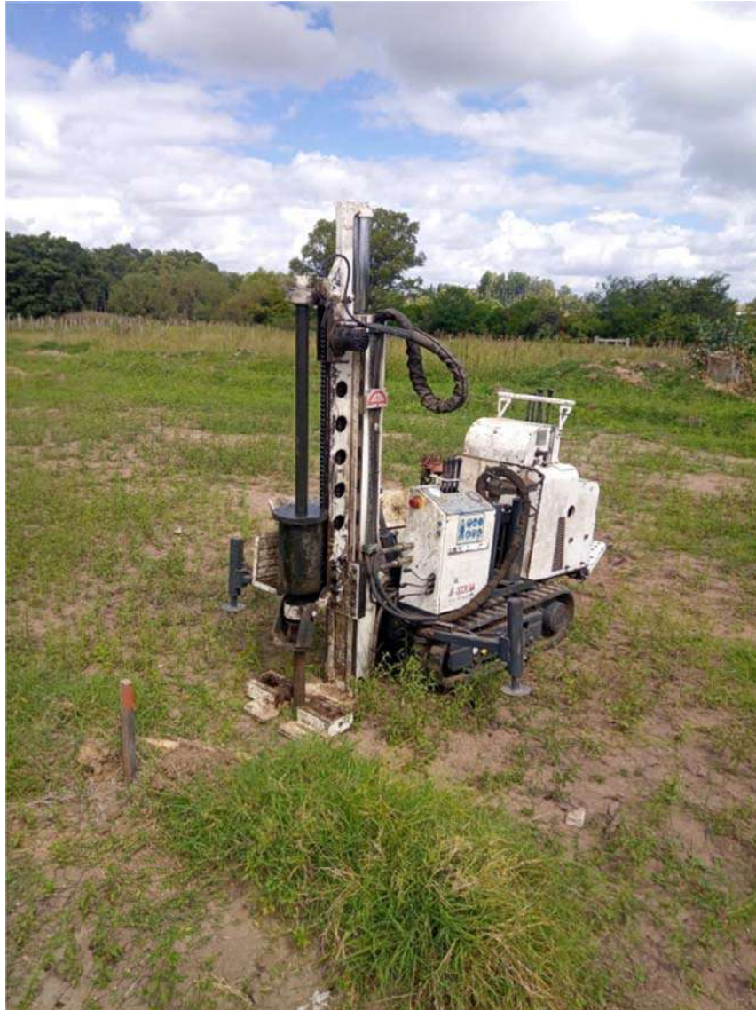
Figura 3. Imagen del Equipo utilizado para el ejecución de los ensayos DSPH
