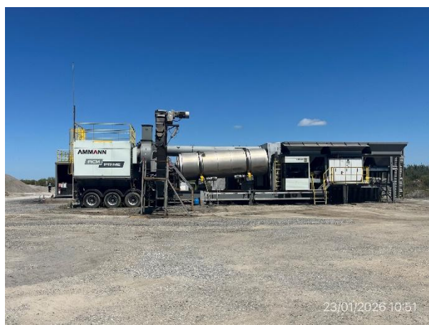
Foto 12.2-4, P03. Planta asfáltica de Grinor SA sin actividad.
