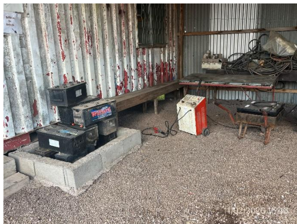
Foto 12.1-8, P03. Taller mecánico, baterías usadas correctamente acopiadas en envallado impermeable.
