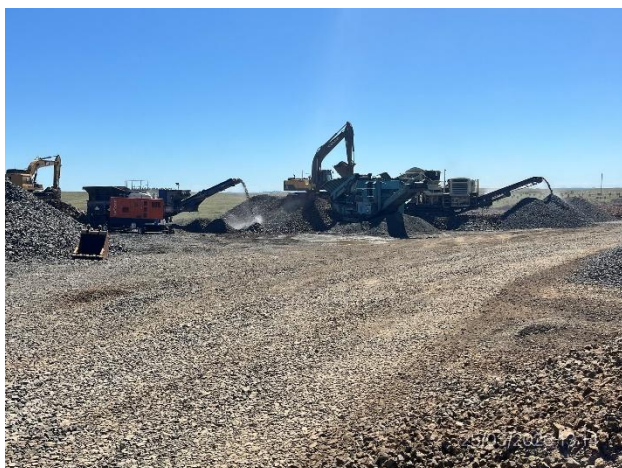
Foto 12.1-13, P03. Planta de trituración. Explanada granular de maniobras y circulación en buenas condiciones.
