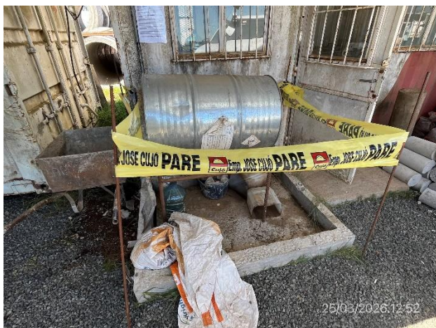
Foto 12.1-11, P03. Laboratorio de asfaltos, acopio de percloroetileno usado correctamente acopiado en recinto envallado y bajo techo.
