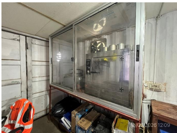
Foto 12.1-5, P06. Laboratorio de asfalto, sector de extracción de asfalto correctamente aislado.
