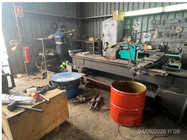
Foto 12.2-7, P05. Obrador, taller mecánico correctamente techado y con pavimento impermeable.
