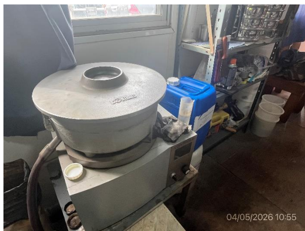
Foto 12.2-4, P05. Laboratorio, sector de extracción de asfalto en buenas condiciones
