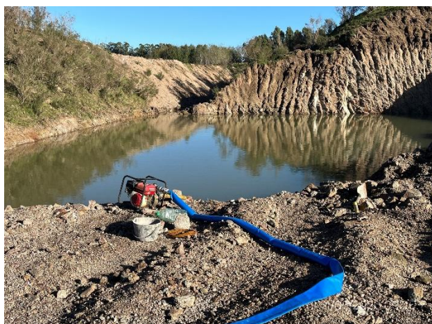
Foto 12.2-11, P03. Cantera granular, se formó tajamar natural. Motobomba en operación sin elementos de contención de eventuales derrames.
