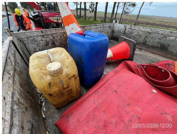
Foto 12.1-12, P07. El móvil de apoyo carece de bandejas estancas para alojar bidones con hidrocarburos y utilizar durante el trasiego de combustibles y lubricantes.
